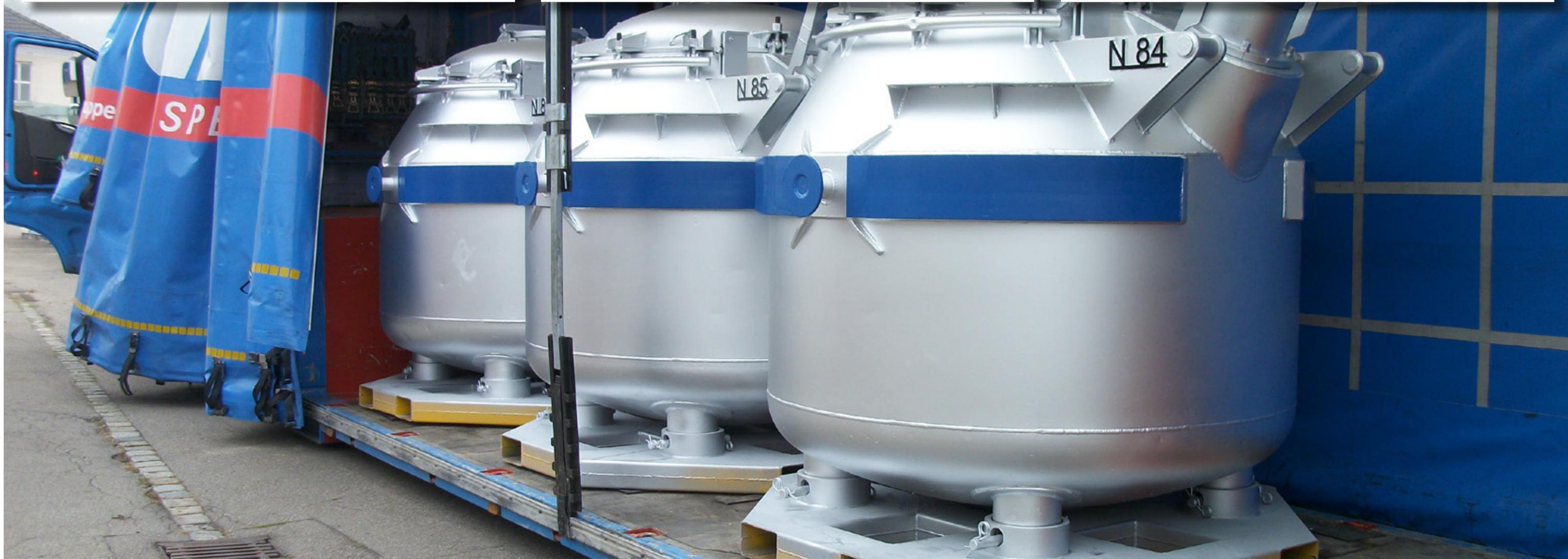
Aufbereitung von Flüssigmetall Transportbehältern
