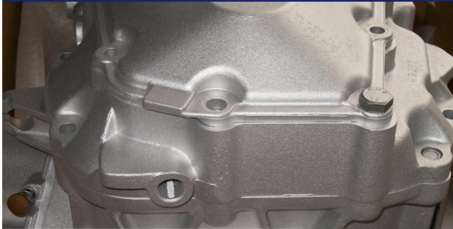
Glasperlgestrahlte Motor- und Getriebeeinheit
