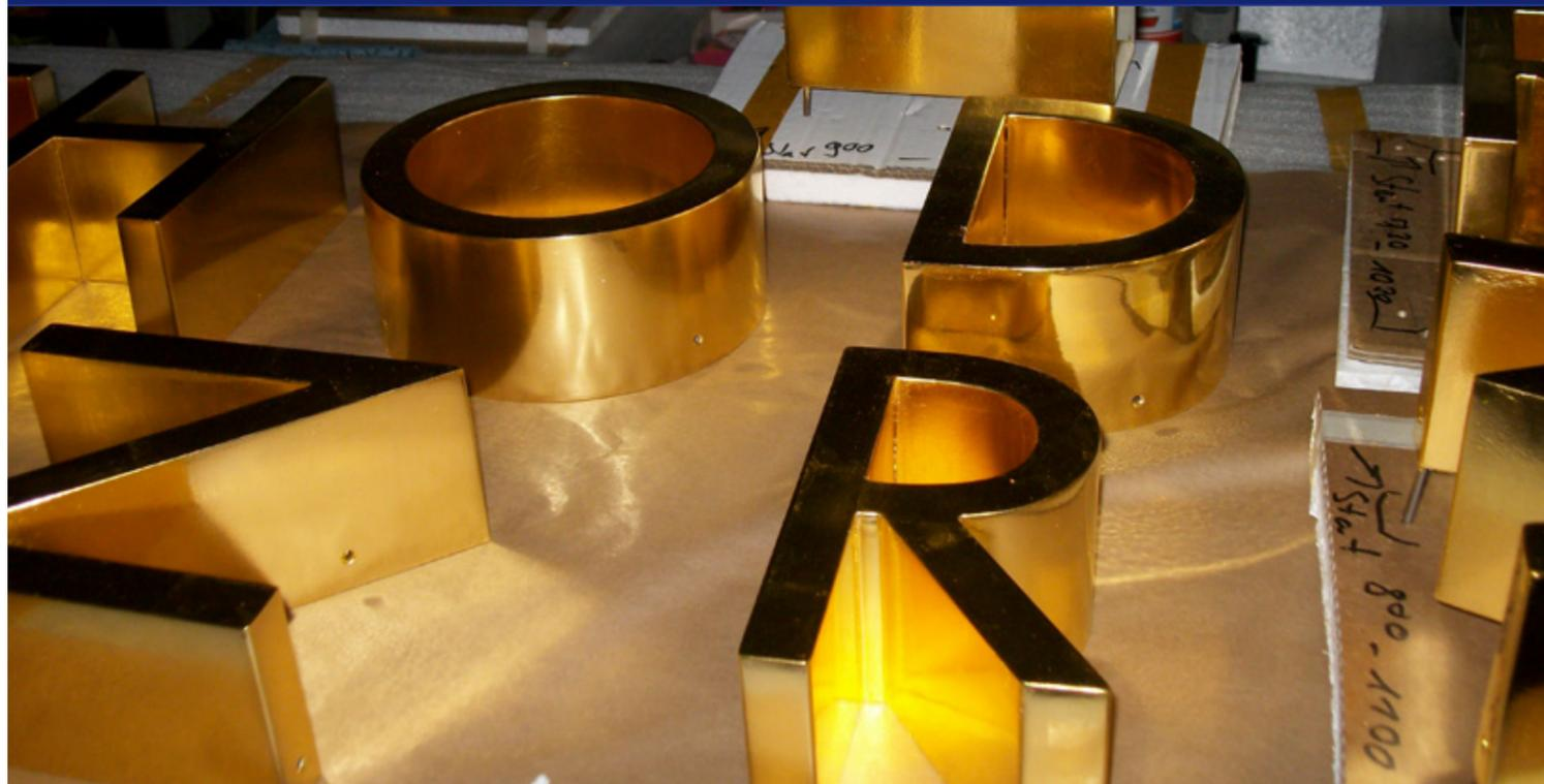
Blattvergoldete Typoelemente einer Fassadebeschriftung
